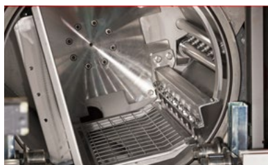
Buses avec pulvérisation optimale et générateur d'ultrasons dans la chambre de travail
