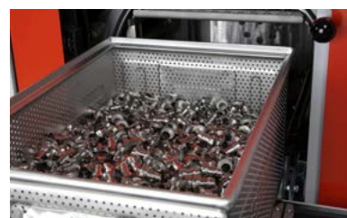
Nettoyage avec une caisse en tôle perforée
