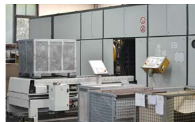
Nettoyage avec des caisses-palettes grillagées (Gitterbox) pour charge utile jusqu'à 1 000 kg
